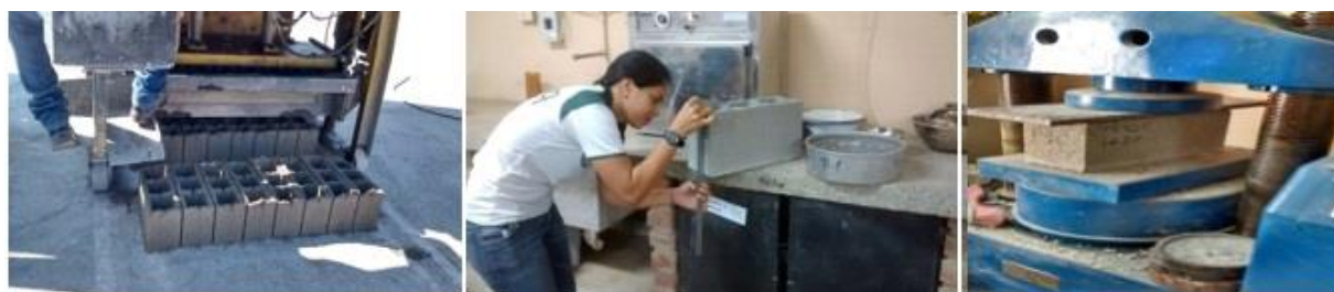
Figura 1. Proceso de elaboración de los bloques de concreto. Fuente: los autores
