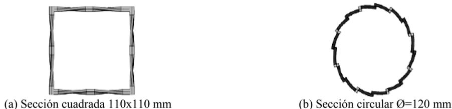
**Figura 2. Geometría de los especímenes ensayados.**
