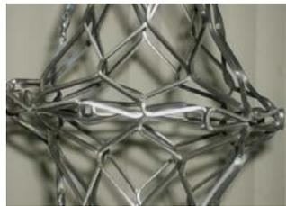
**Figura 27. Deformación de las celdas para la orientación  $\alpha=90^\circ$ .**
