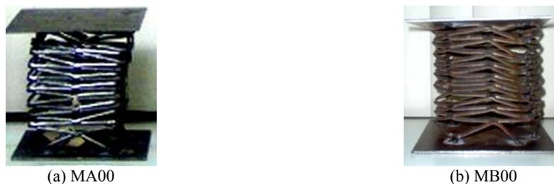
**Figura 17. Configuración final para los Modelos en la orientación  $\alpha=0^\circ$ .**
