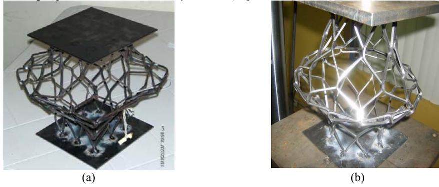
**Figura 28. Estado final de los modelos en la orientación  $\alpha=90^\circ$ .
