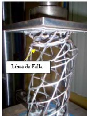
Figura 22. Secuencia de deformación de las celdas en la orientación  $\alpha=45^\circ$ .
