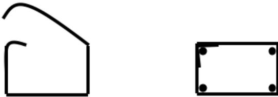
Figura 33. Ganchos en estribos inadecuados
