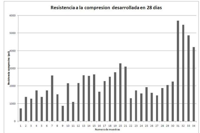
**Figura 7.** Valores de resistencia compresiva de las 34 muestras
