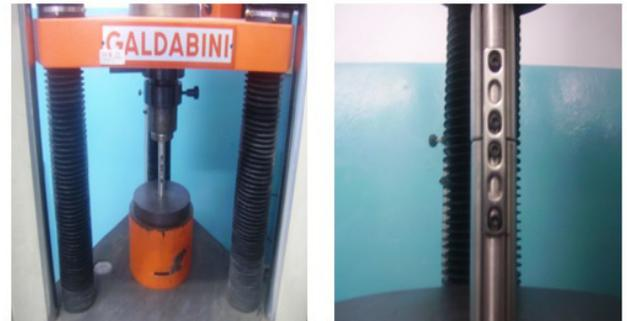
**Figura 12.** Montaje del sistema placa-barra-tornillos en la máquina GALDABINI
