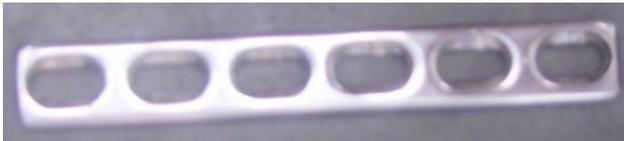
**Figura 10.** Modelo construido de la placa para la fijación de fractura del antebrazo
