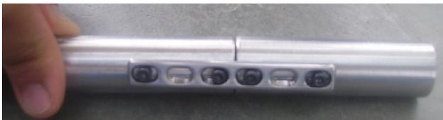
**Figura 11.** Ensamble del sistema placa-tornillos
