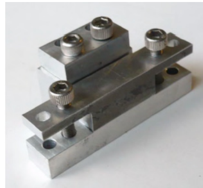
Figura 34. Ensamblaje del estampador de unión
