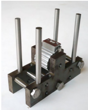
Figura 39. Ensamblaje parte inferior del conformador de bumps
