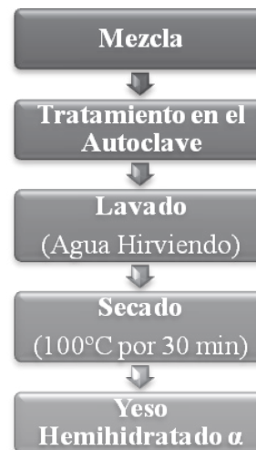
Figura 1. Diagrama de flujo del proceso de obtención del yeso HH \alpha
