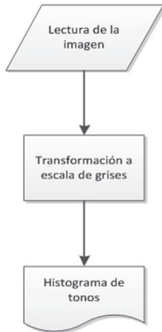
Figura 1. Diagrama de flujo del módulo de lectura y tratamiento primario
