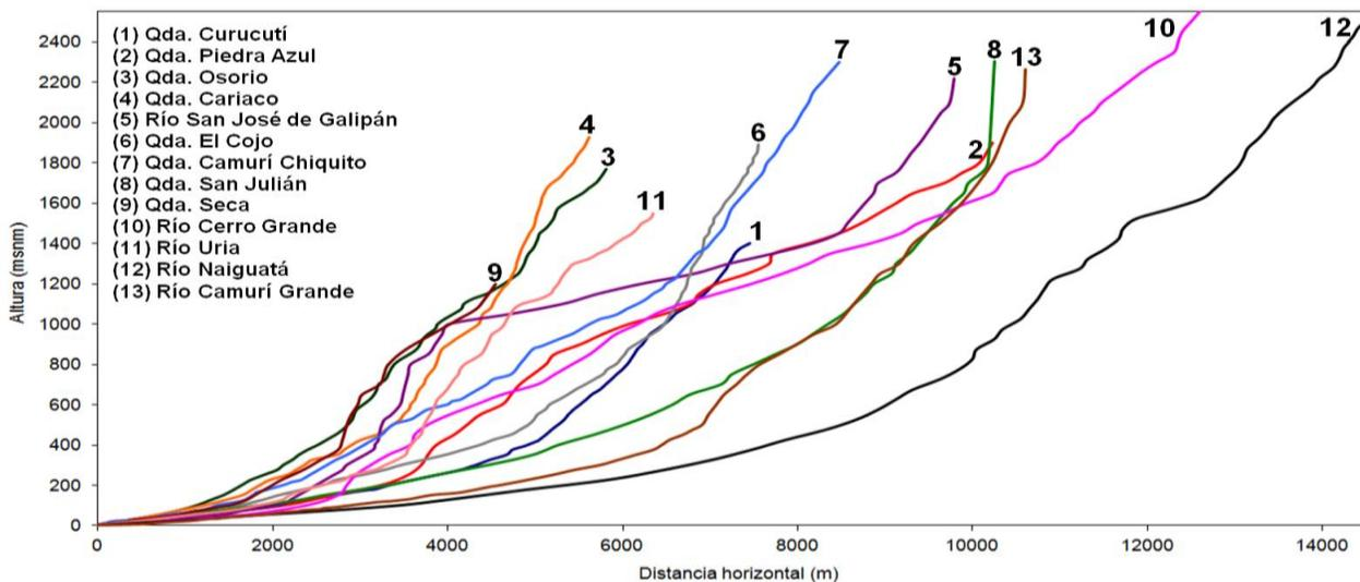
**Gráfico 7.** Perfiles topográficos longitudinales de los cauces principales de ríos y quebradas de la vertiente norte del macizo El Ávila, estado Vargas, Venezuela. Perfiles elaborados a partir de planos topográficos a escala 1:5.000 por DCN, 1958, Caracas; y planos topográficos del “*Proyecto BITUCOTEX*” a escala 1:5.000 por GDF, 1984, Caracas.
