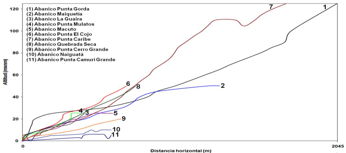
**Gráfico 8.** Perfiles topográficos longitudinales de los abanicos aluviales de la vertiente norte del macizo El Ávila, estado Vargas, Venezuela. Perfiles elaborados a partir de planos topográficos a escala 1:5.000 por DCN, 1958, Caracas; y planos topográficos del “Proyecto BITUCOTEX” a escala.
