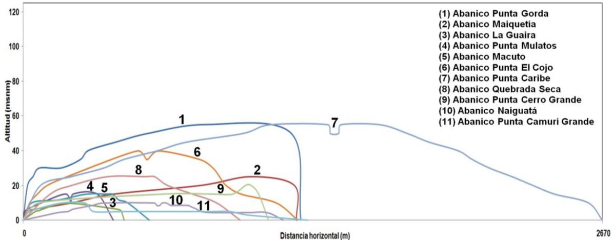
**Gráfico 9.** Perfiles topográficos transversales de los abanicos aluviales de la vertiente norte del macizo El Ávila, estado Vargas, Venezuela. Perfiles elaborados a partir de planos topográficos a escala 1:5.000 por DCN, 1958, Caracas; y planos topográficos del “Proyecto BITUCOTEX” a escala 1:5.000 por GDF, 1984, Caracas.
