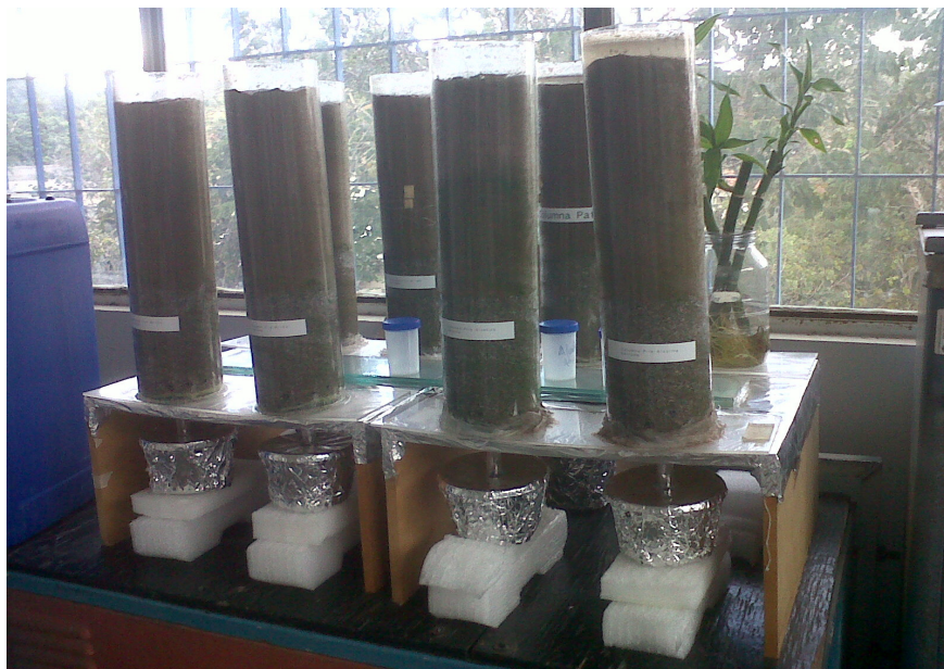
Figura 2. Fotografía de las columnas de percolación ensambladas y con las muestras de pilas gastadas en su interior.
