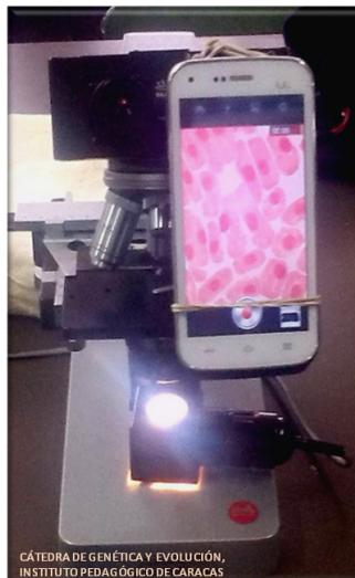
**Figura 2.** Base de ajuste para teléfonos celulares que permite acoplar la cámara digital a uno de los oculares de lupas estereoscópicas o microscopios ópticos.
