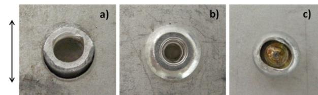
**Figura 9.** Fractura a tensión/cortante del remache a) Superficie de fractura, b) Vista superior de la lámina superior, c) Vista posterior de la lámina inferior.
