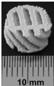
**Figura 10.** Andamio de HA después de sinterizado [28].
