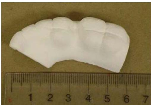
Figura 17. Muestra de HA impregnada con bis-GMA [33].
