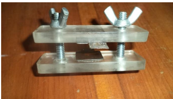
Figura 1. Celda para muestras sólidas utilizada para las medidas de voltamperometría cíclica y espectroscopia de impedancia electroquímica
