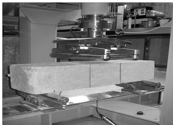
**Figura 5.** Configuración del ensayo de módulo de rotura.
