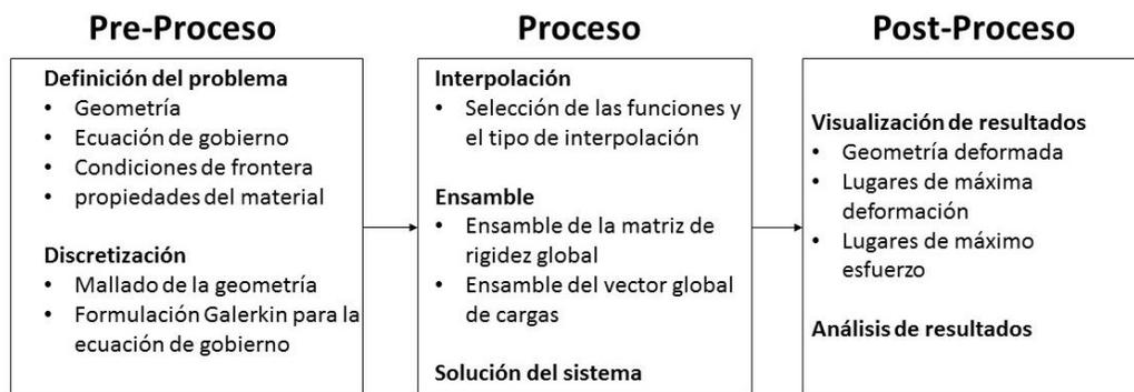
Figura 4. Metodología para la implementación del método del elemento finito.
