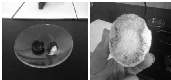
Figura 5. Estado final de la espuma sólida de celulosa, luego de aplicar la prueba de resistencia al fuego mediante calentamiento directo (izquierda) e indirecto (derecha).
