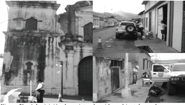
Figura 2b : Adquisición de registro de ruido ambiental usando un sensor de tres componentes broadband (flecha)
