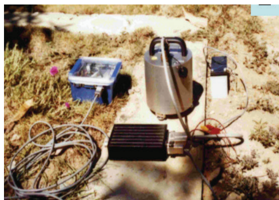
Figura 2a. Equipo usado para el registro del ruido ambiental para la obtención posterior de los microtremores.
