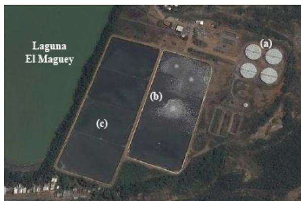
Figura 2. Disposición de las unidades para el tratamiento biológico de la planta El Maguey: (a) reactores UASB, (b) laguna parcialmente aireada, (c) laguna de maduración (Fuente: Google™ Earth 2013).
