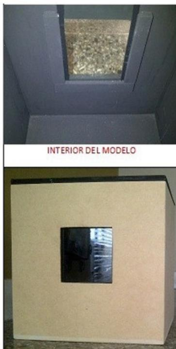
Figura 1. Modelo a escala con abertura lateral (Elaboración propia, 2014).
