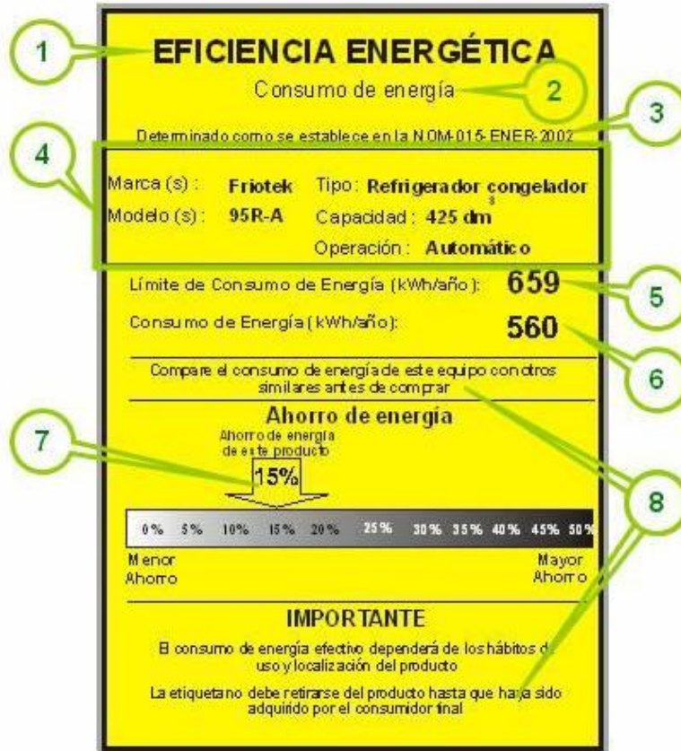
Figura 3. Etiqueta amarilla de equipos de refrigeración.
