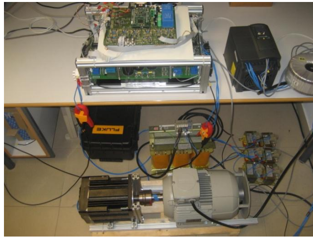
Figura 6. Prototipo Sistema de Conversión de Energía Eólica.
