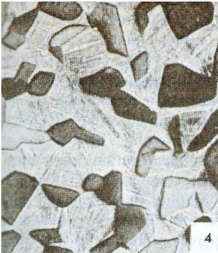
Figura 17.  $\alpha$  masivo en borde de grano de  $\beta$  y  $\alpha$ -Widmanstätten en una matriz martensítica descompuesta. Ataque: cloruro de bencol + HF [6]
