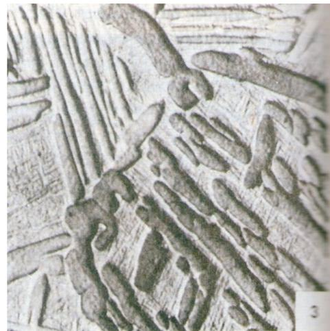
Figura 19. Coalescencia de granos facetados de  $\alpha$  (oscuros) en una matriz de martensita descompuesta. Ataque: cloruro de bencol + HF [6]
