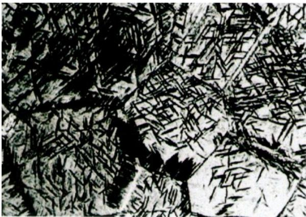
Figura 16. Ti-6Al-4V, granos equiaxiales de  $\alpha$  (oscuro) en una matriz de  $\beta$  retenida (claro). Ataque: cloruro de bencol + HF [6]
