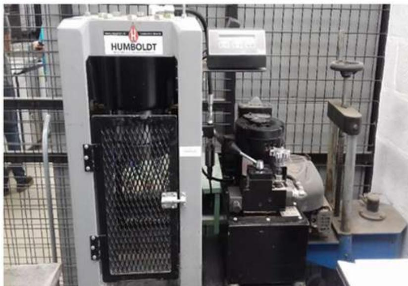
**Figura 2.** Máquina de compresión Humboldt.
